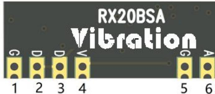
图 1 RX20BSA 管脚示意图
