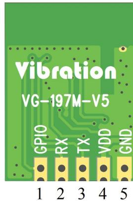
图 1 VG197MU 管脚示意图
