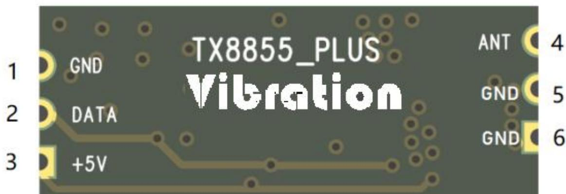
图 1 TX8855\_PLUS 管脚示意图
