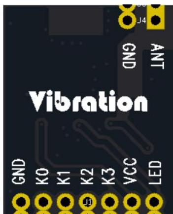
图 1 TM-03 管脚示意图
