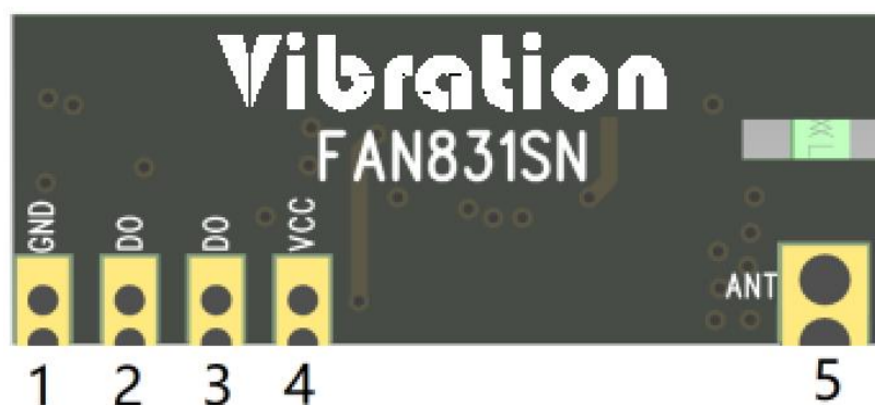
图 1 FAN831SN 管脚示意图
